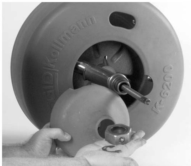
Figure 13 – Retrait de la bague de retenue et du tambour interne
