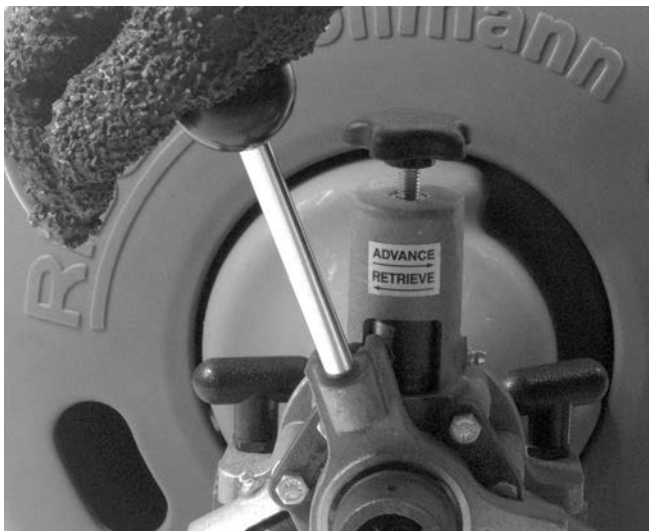
Figura 9 – Funcionamiento de la palanca de autoalimentación
