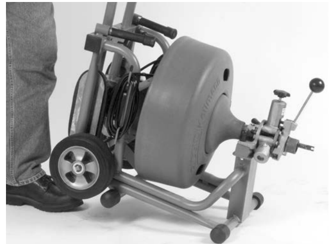
Figure 7 – Repliement de la béquille
