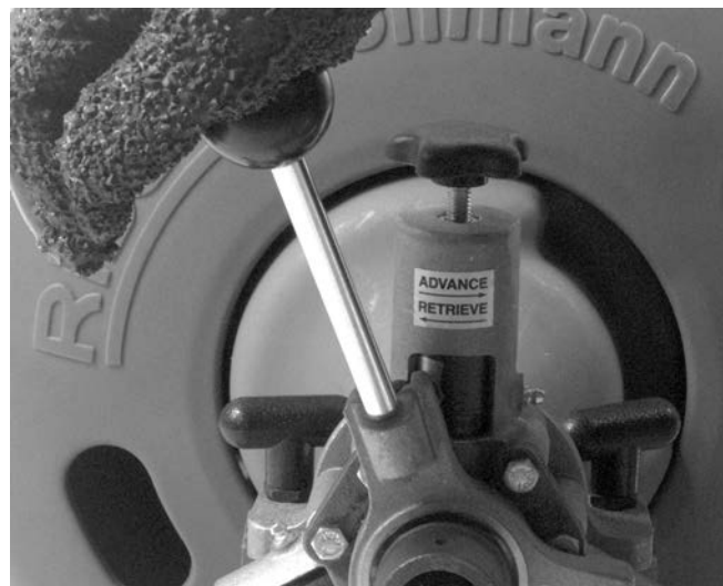
Figure 9 – Fonctionnement du levier d'avancement
