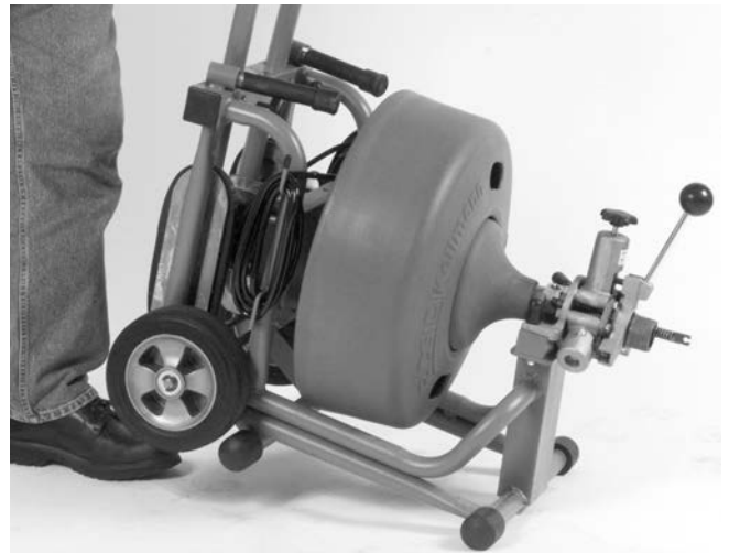
Figura 7 – Inclíne la máquina hacia adelante para desenganchar la barra apoyapiés
