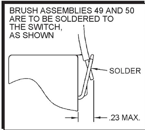
BRUSH ASSEMBLIES 49 AND 50 ARE TO BE SOLDERED TO THE SWITCH, AS SHOWN
